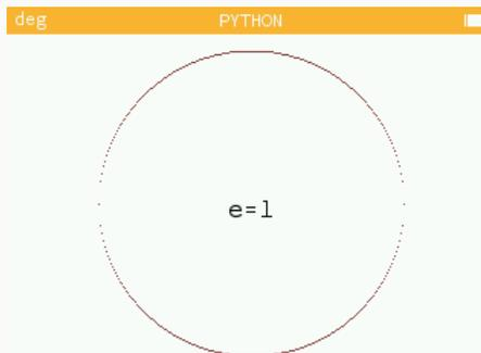
Transformée en programme, cette formule trace un cercle avec des trous sur les bords, car il y a trop peu de pixels utilisés lorsque  $x$  s'approche de sa valeur minimale  $x_0 - R$  ou de sa valeur maximale  $x_0 + R$ .
