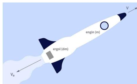
1. Exprimer, dans un premier temps, la quantité de mouvement de l'engin spatial au cours de la poussée. On notera  $dm$  la variation de la masse de carburant après un instant  $dt$ , avec  $dm < 0$ , et  $d\vec{v}$  la vitesse
